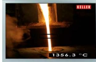
Eine weitere Besonderheit ist die TBC-Funktion (Target Brightness Control). Die Belichtungsregelung der Kamera ermittelt die Lichtstärke nicht wie sonst üblich aus dem Mittelwert des Gesamtbildes, sondern exakt im Messfeld des Pyrometers. Daher wird
