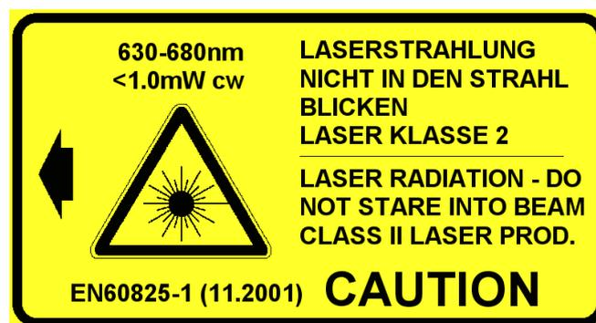
Abb. 3.2 Am Pyrometer angebrachtes Laserwarnschild
