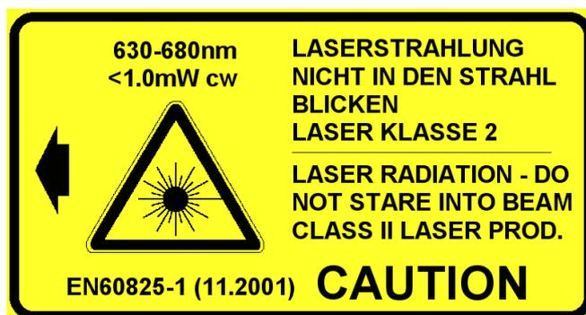
Abbildung 1: Am Pyrometer angebrachtes Laserwarnschild
