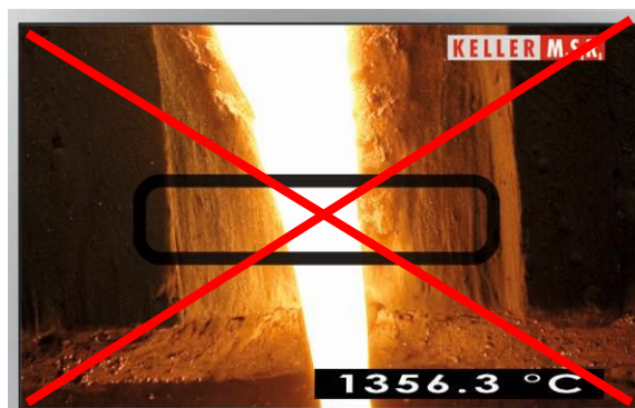
Fehlerhafte Ausrichtung des Messfeldes auf die Gießrinne (heißer Hintergrund)
