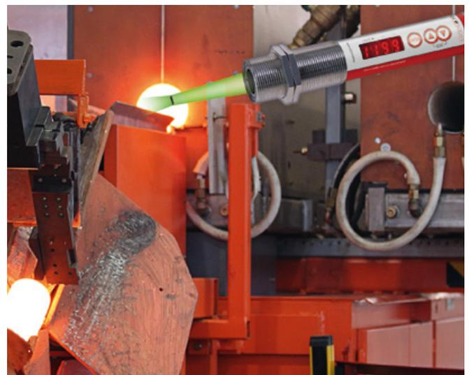
**Fig. 2** Les billettes trop chaudes ou froides sont écartées par les sorties relais
