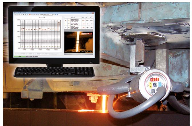
**Image 4** Point de mesure de l'automate de coulée et moniteur pour l'affichage de la température de coulée et de l'image vidéo.
