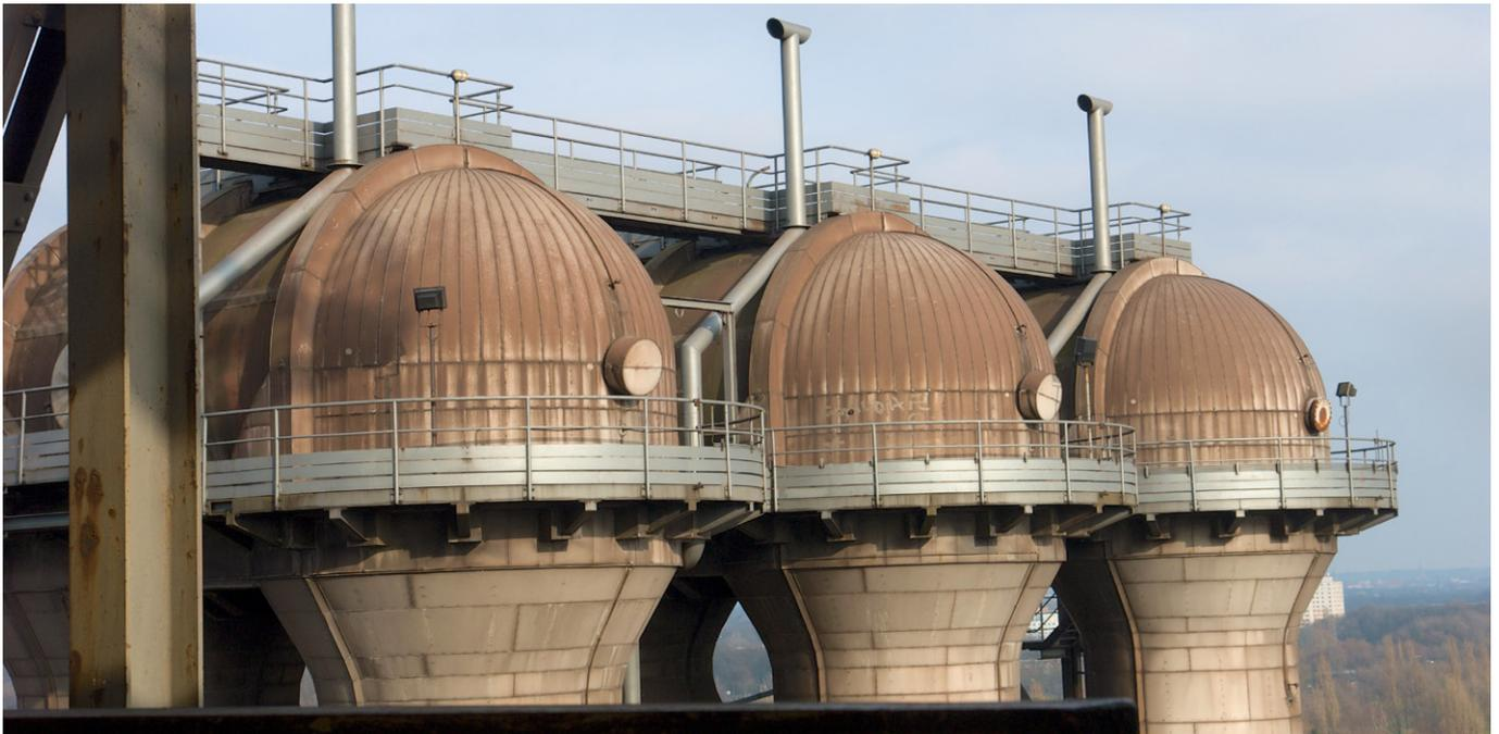
**Image 1** Des pyromètres mesurent depuis le dôme la température des briques creuses dans le cowper.
