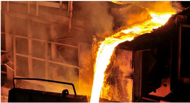
**Image 3** Point de mesure du chenal de coulée avec scories et oxydes sur la masse fondue en écoulement.
