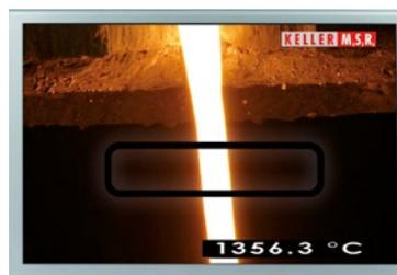
L'ajustement de la focale peut se faire soit par la visée directe, le pointeur laser ou la caméra vidéo couleur. La cible délimite clairement la zone de mesure. L'instrument peut être connecté via l'USB ou la RS 485 à un PC pour une visualisation et un enregistrement des données. Le logiciel CellaView est libre d'accès.
