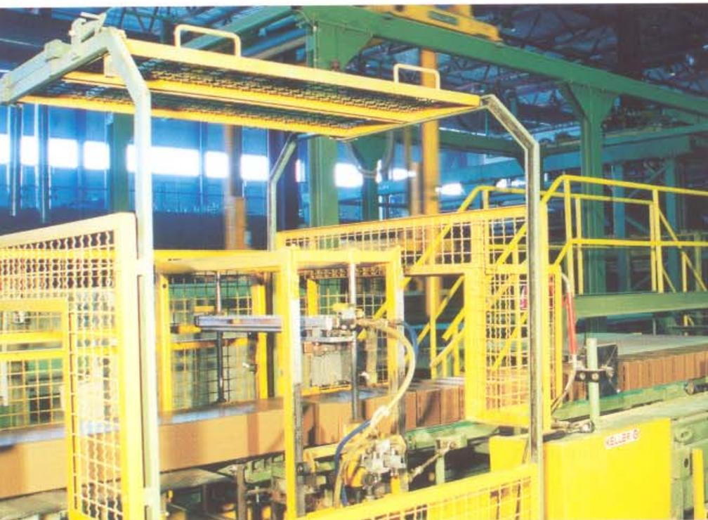
Тележка и электро-передаточная платформа загружают камерную сушилку.
