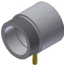
Die Axialluftdüse PZ 20/A sorgt für eine zirkuläre Luftströmung. In Verbindung mit dem Zwischenrohr PZ 20/C und der Staubblende PZ 10/T wird bereits bei minimalem Luftverbrauch eine Verschmutzung der Optik des Pyrometers vermieden.
