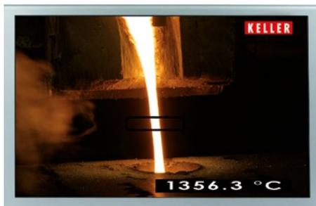
La señal de video también transmite los datos de medida y una imagen sobreimpresionada en la pantalla da el valor de la temperatura.
