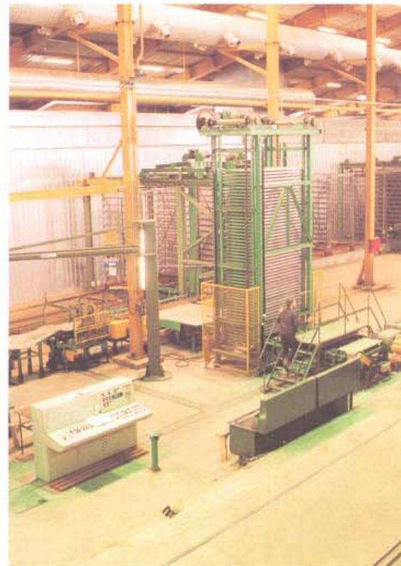
Die Naßseite mit KELLER Universal-Abschneider, Lattenautomatik und Tunneltrocknerwagenbeladung.
