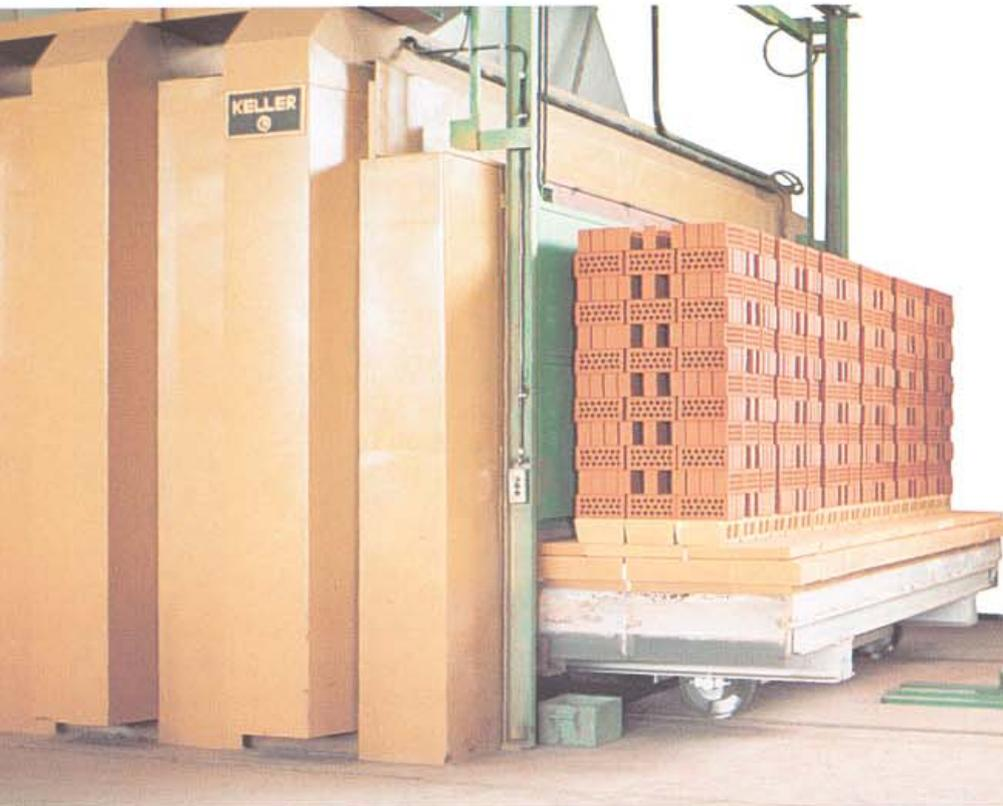
Tunnelofenausfahrt mit einem Tunnelofenwagen mit gebrannten Steinen.
