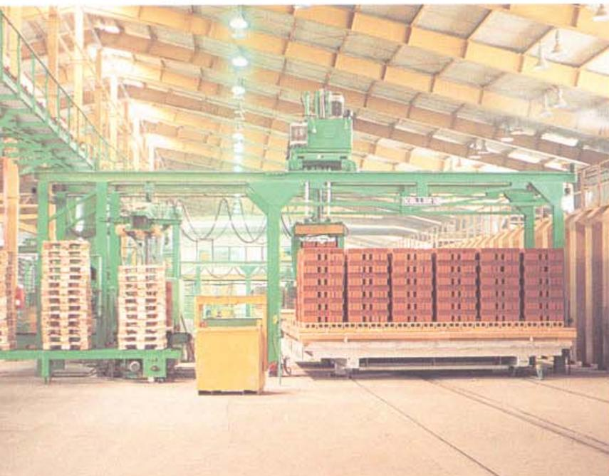
Entladegreifer zum paketweise Entladen der Tunnelofenwagen.
