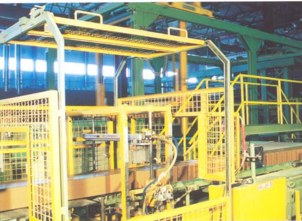
Тележка и электро-передаточная платформа загружают камерную сушилку.
