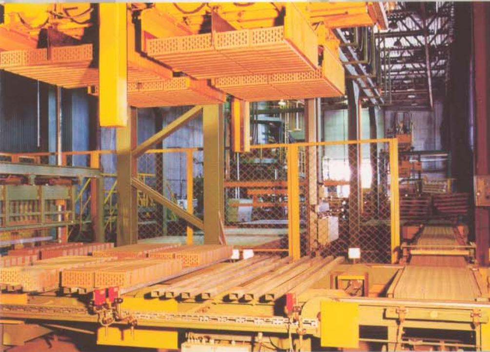
Die automatisch gesteuerte Setzmaschine setzt die getrockneten Formlinge nach einem vorbestimmten Setzschema auf die Tunnelofenwagen. Vier drehbare Setzgreifer setzen die getrockneten Formlinge im Kreuzverband ab.
