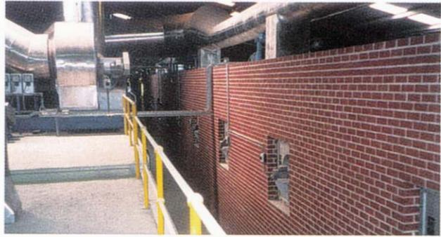
Die Umwälzventilatorantriebe des Tunneltrockners befinden sich auf idealer Wartungshöhe
