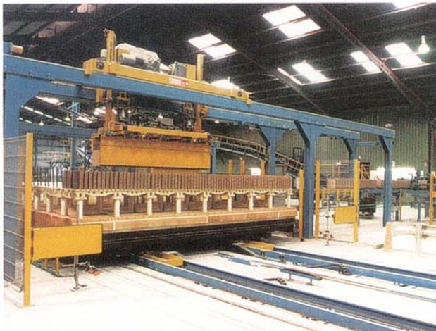
Die Spaltplatten werden mit dem Entladegreifer abgehoben
