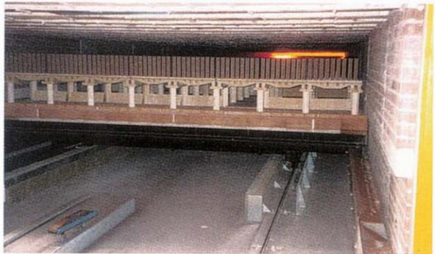
Blick in den Tunnelofen und auf die Radkühlung für die TOW – bei geöffnetem Ofenausfahrttor
