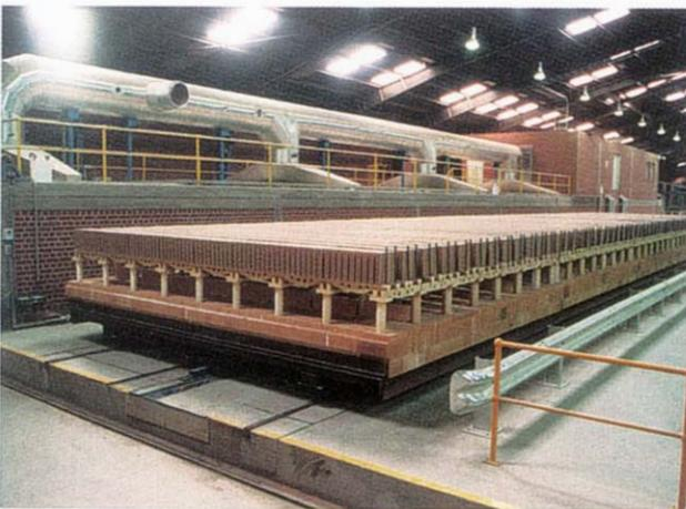
Gesetzte Ofenwagen vor dem Nassspeicher mit aufgesetzter Schaltwarte
