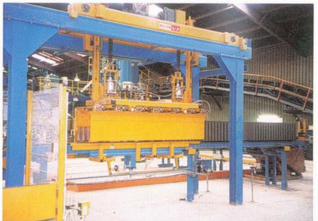
Der Spaltplatten-Setzgreifer ist zum Aufnehmen einer Formlingsreihe bereit
