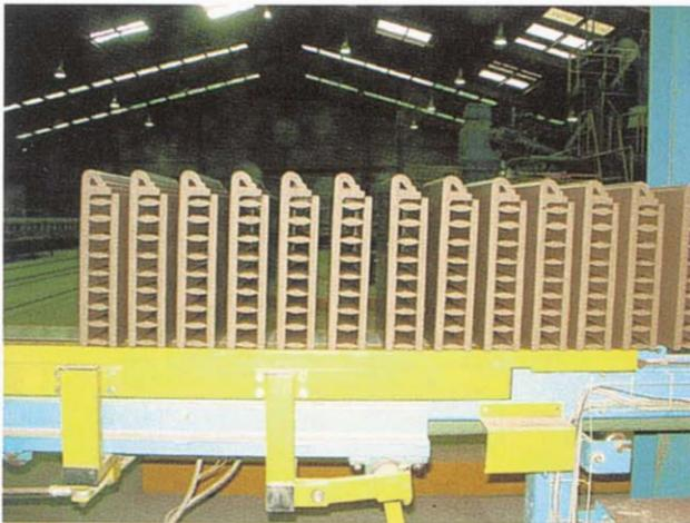
Gruppierte Spaltplatten-Treppenstufen im Bereich der Hub-/Schränkleisten
