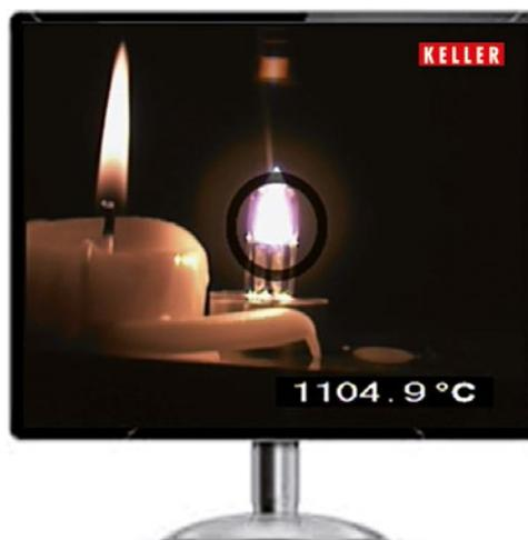
Gracias al control de exposición automático con la función TBC, se logra una exposición óptima del campo de medición en todo momento. En la imagen se visualiza la marcación del campo de medición y el valor medido. La lectura de la temperatura y la marcación del blanco se superponen a la imagen.
