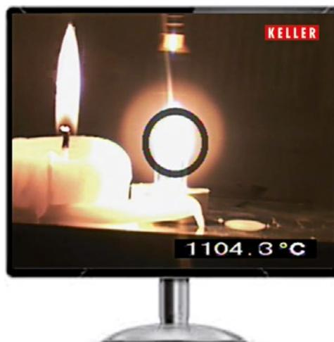
Sin disponer de la función TBC, la intensidad luminosa se promedia a partir de la iluminación total. Un objeto de medición brillante delante de un fondo oscuro estará sobreexpuesto.
