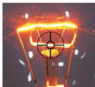
En el visor se muestra exactamente el tamaño y la posición del área de medición. Para proteger el ojo durante la medición de objetos muy brillantes, se puede montar el filtro de polarización PA 20/P. En los dispositivos con un rango de medición > 2000 °C, este filtro viene integrado de serie.
