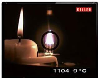
Gracias al control de exposición automático con la función TBC, se logra una exposición óptima del campo de medición en todo momento. En la imagen se visualiza la marcación del campo de medición y el valor medido. La lectura de la temperatura y la marcación del blanco se superponen a la imagen.
