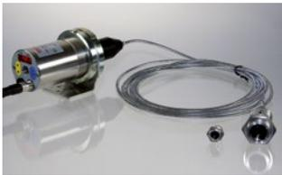
En los pirómetros con cable de fibra óptica la parte electrónica se encuentra separada de la parte óptica. Un cable de fibra óptica transmite la radiación infrarroja detectada por el cabezal de medición a la parte electrónica, lo que permite su uso en ambientes con temperaturas hasta 250 °C sin necesidad de refrigeración.
