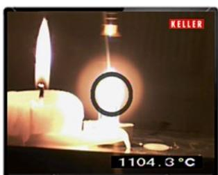
Sin disponer de la función TBC, la intensidad luminosa se promediaría a partir de la iluminación total. Un objeto de medición brillante delante de un fondo oscuro estará sobreexpuesta.
