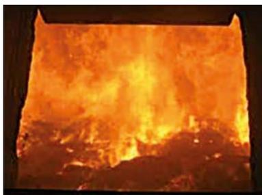
El CellaPort PT 113 fue especialmente diseñado para medir temperaturas en hornos calentados por llamas. Gracias al rango espectral selectivo de 3,9  $\mu\text{m}$ , vapor de agua y  $\text{CO}_2$  presentes en el campo de visión del pirómetro no afectan a la lectura de temperatura, incluso
