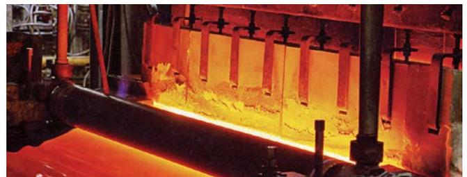
Con su filtro de bloqueo con una sensibilidad espectral entre 4,6 y 4,9  $\mu\text{m}$ , el CellaPort PT 115 detecta la temperatura en el área cercana a la superficie del vidrio. En esta longitud de onda las variaciones en el espesor o en la humedad de la atmósfera o modificaciones del tipo de vidrio no afectan a los valores medidos.
