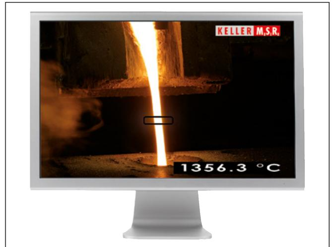
**Bild 8** Videobild mit Messfeldmarkierung und eingblendeter Temperaturanzeige
