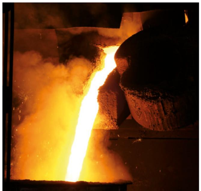
**Bild 4** Umfüllen des Eisens vom Schmelzofen in die Gießpfanne
