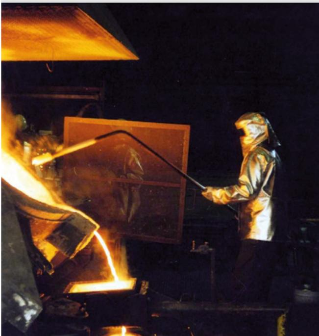
**Bild 1** *Herkömmliche Temperaturmessung von flüssigem Metall mit der Tauchsonde*
