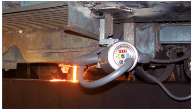
**Bild 5** Optische Temperaturmessung am Gießautomaten
