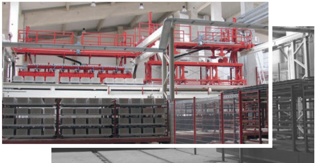
Robots industriels à 4 axes pour l'empilage des wagons de four
