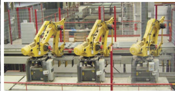
Chargement des claies de séchage via des robots industriels à 4 axes
