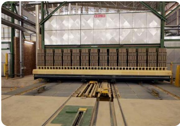
Pour un processus de séchage optimal, les orifices d'insufflation sont réglables. L'association de la technologie de séchage utilisée avec le réseau de chaleur optimisé des fours tunnels fait de l'installation de séchage un système de séchage très efficace, moderne et respectueux des produits.
