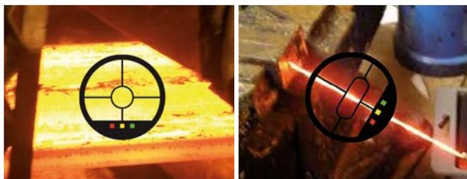
En mode mono-chromatique, l'objet doit recouvrir entièrement la cible. La cible indique la surface exacte de mesure.
