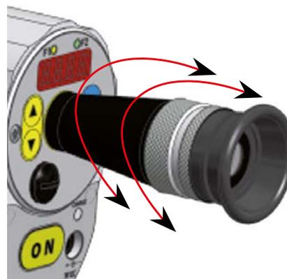
Réglage de l'oculaire et du polariseur
