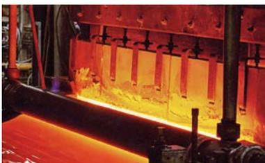
Gur la plage spectrale 4.5 - 8  $\mu\text{m}$ , le verre a une émissivité proche de 100%. Au dessus de 5  $\mu\text{m}$ , la présence de vapeur d'eau perturbe la mesure.
