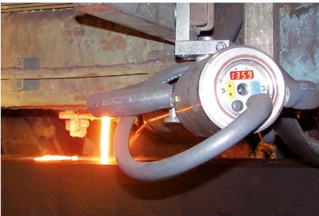
Détecter la température du métal liquide par des moyens optiques est particulièrement difficile en raison de la formation de laitier et d'oxydes en surface. Chaque oxyde n'émet pas la même quantité d'énergie pour une température donnée. Pour obtenir une mesure fiable et précise, il est essentiel que le pyromètre détecte les zones sans oxyde ni impureté. Cette fonction est assurée par le CSD (Clean Surface Detection).
