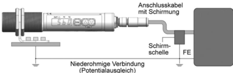
Bei Potentialdifferenzen zwischen den Erdungspunkten kann über den beidseitig angeschlossenen Schirm ein Ausgleichsstrom fließen. Verlegen Sie in diesem Fall eine zusätzliche Potentialausgleichsleitung.
